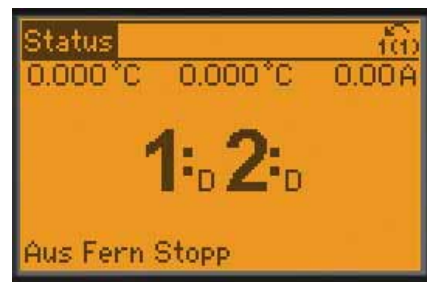
El estado del compresor puede leerse directamente en el display. D = control de velocidad variable, O = Off, R = funcionamiento de red, X = Desactivado
